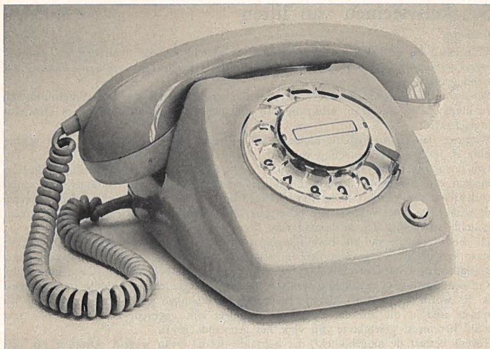
Het kiesschijf-telefoon toestel T 65 dat geleidelijk aan verdrongen zal worden door een toestel met druktoetsen
